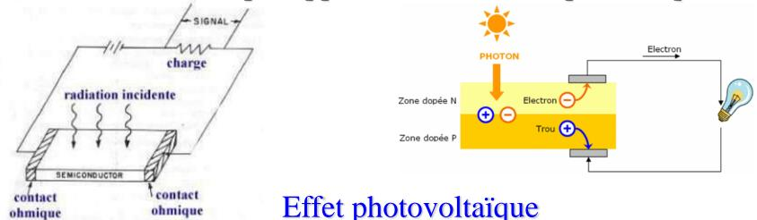
Des électrons et des trous sont libérer au voisinage d'une jonction PN illuminée; leur déplacement modifie la tension à ses bornes.
