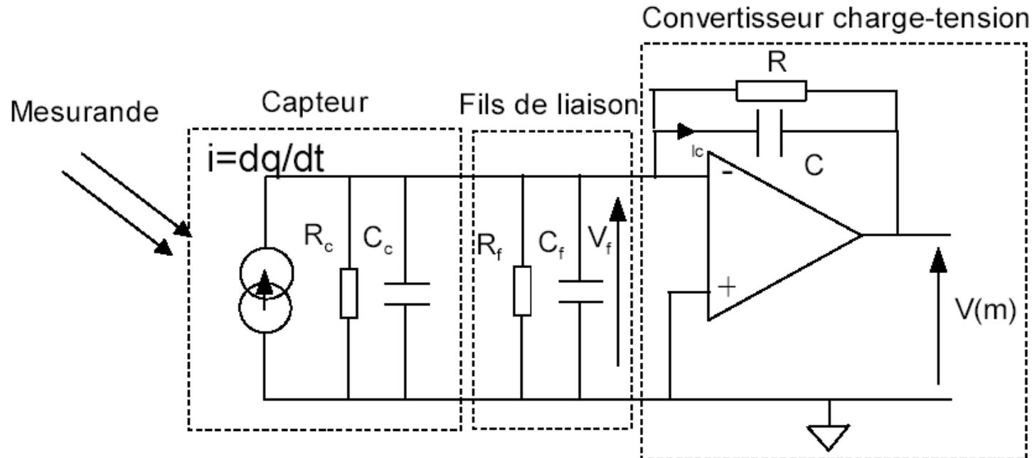
$$V(m) = -\frac{Q}{C} \cdot \frac{jRC\omega}{1 + jRC\omega}$$
