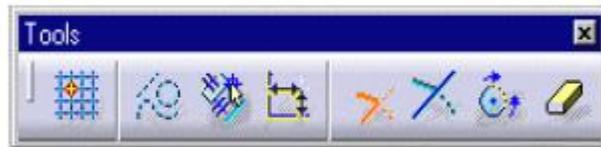
Si l'icône gomme est enfoncée, cela permet de supprimer certains éléments si ceux-ci intersectent d'autres éléments du sketcher. Un exemple est illustré sur la figure ci-dessous :
