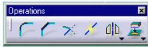
La fonction de relimitation est particulièrement intéressante pour les profils complexes. Lorsqu'on clique sur l'icône, la barre d'options apparaît.
