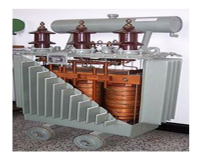
pour les transformateurs les plus puissants, par exemple ceux des grandes lignes THT de 400 à 150 kV, on utilise des systèmes de ventilation forcée d'un important flux d'air associé ou non à un échange thermique avec l'huile de la cuve. Le dispositif de refroidissement est toujours couplé à un système de capteurs de température faisant office de thermostat (commande automatique de la mise en route de la ventilation).
