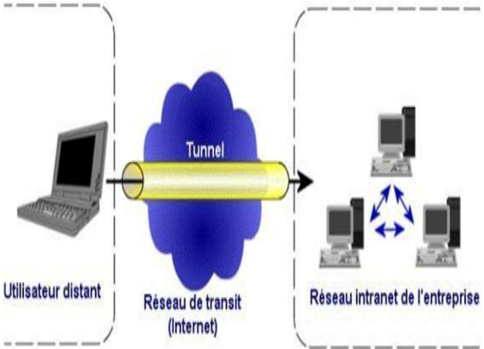
Le principe de **tunneling** consiste à construire un chemin virtuel après avoir identifié l'émetteur et le destinataire.
