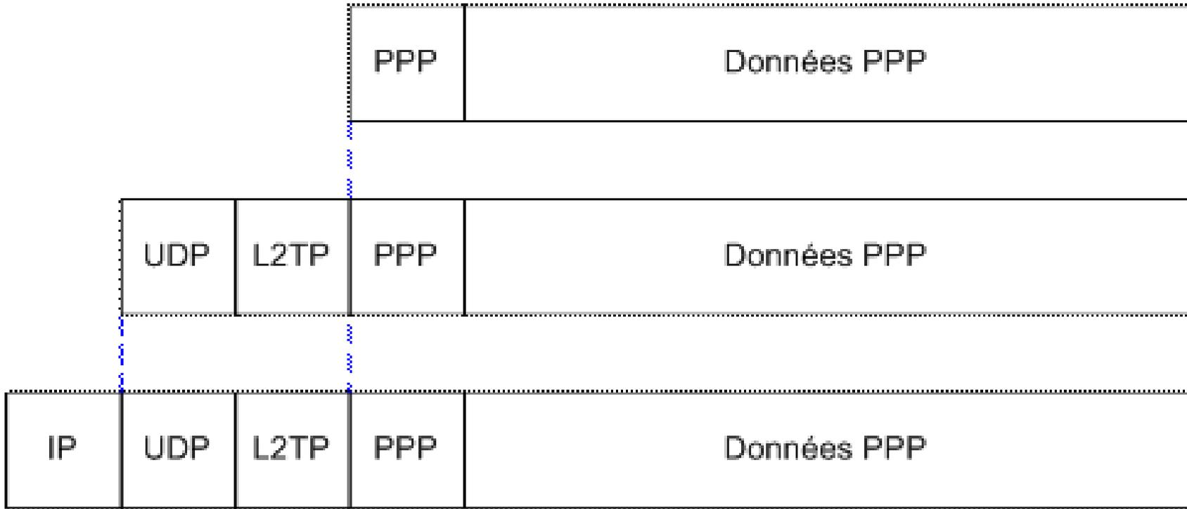
**Le protocole L2TP transporte des trames PPP dans des paquets IP.**
